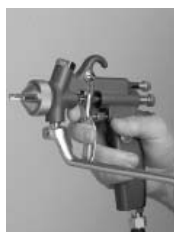
2. Proppen løsnes med en 17" nøgle, skrues ud.
