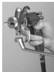
4. Dobbeltnippel 1/4" - 3/8" skrues i og spændes med en 17" nøgle.
