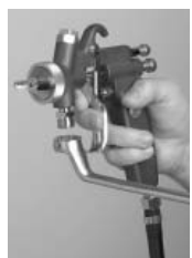
4. Visser le double nipple 1/4 - 3/8" et serrer (clé de 17).
