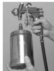
6. Alternatief: onderbeker bevestigen (alleen bij HD-uitvoering mogelijk); luchtkap verwisselen (HD-luchtkap).
